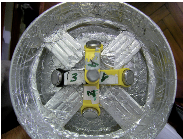
Slika 7. Razporeditev gumbkov v AP zaklonu pri preskusu vpliva usmerjenosti gumbka (Foto: I. Sinjur)
